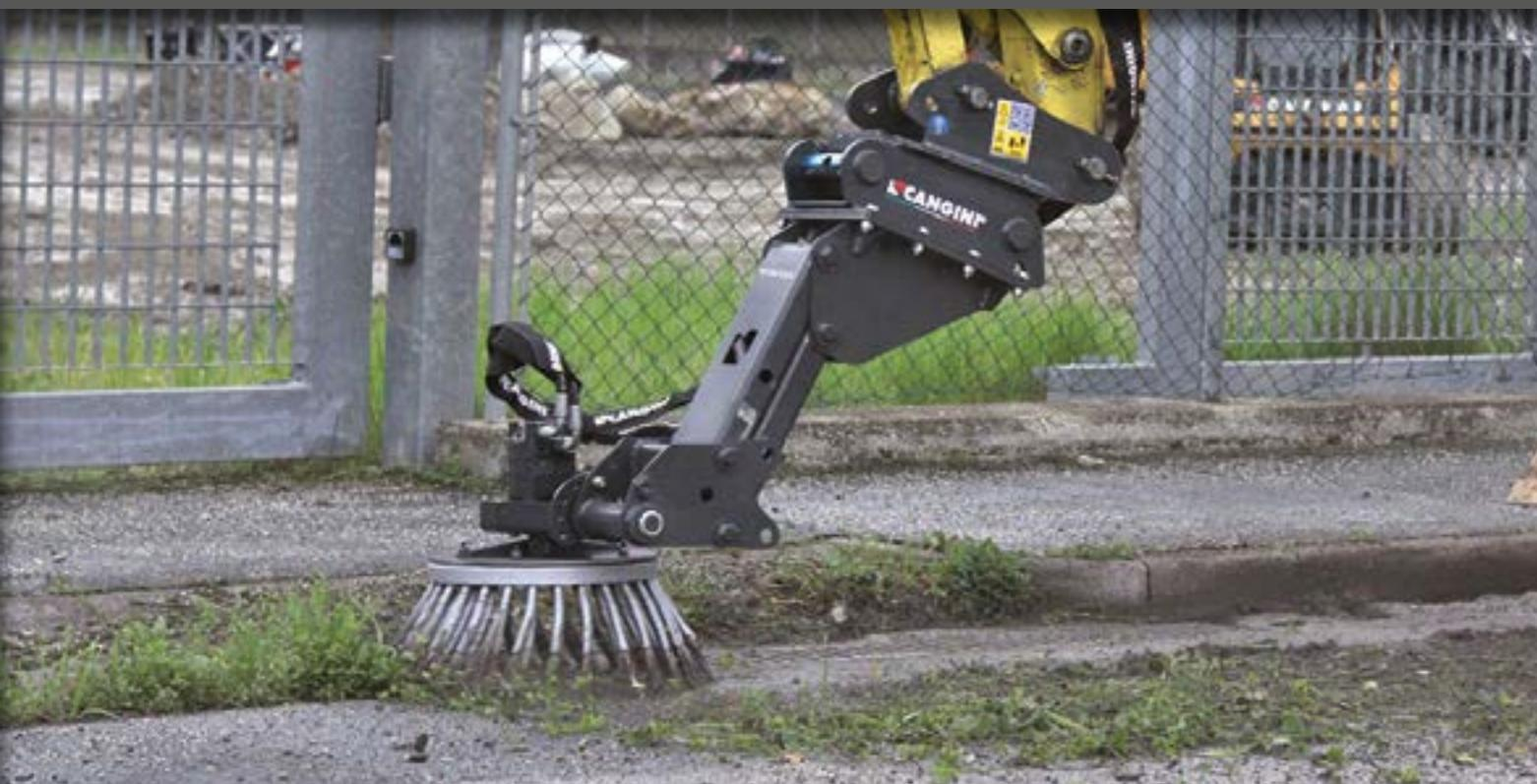
GLENBURSTE MIT STAHLBORSTEN, DAHER IDEAL FÜR TIEFES AUSKEHREN ODER DAS ENTFERNEN VON UNKRAUT AN BORDSTEINEN, GEHWEGEN, BANKETTEN ODER ASPHALT. FÜR EINE OPTIMALE ANPASSUNG AN DEN ZU REINIGENDEN UNTERGRUND IST DIE BÜRSTE IST ZWEIFACH GELAGERT. BEIDE MECHANISMEN KÖNNEN BEI BEDARF ARRETIERT WERDEN. MIT DER "PP-BÜRSTE" (ZUBEHÖR) WERDEN EMPFINDLICHE FLÄCHEN GEKEHRT, BEI DENEN DIE ENTFERNUNG VON UNKRAUT NICHT NOTWENDIG IST.
