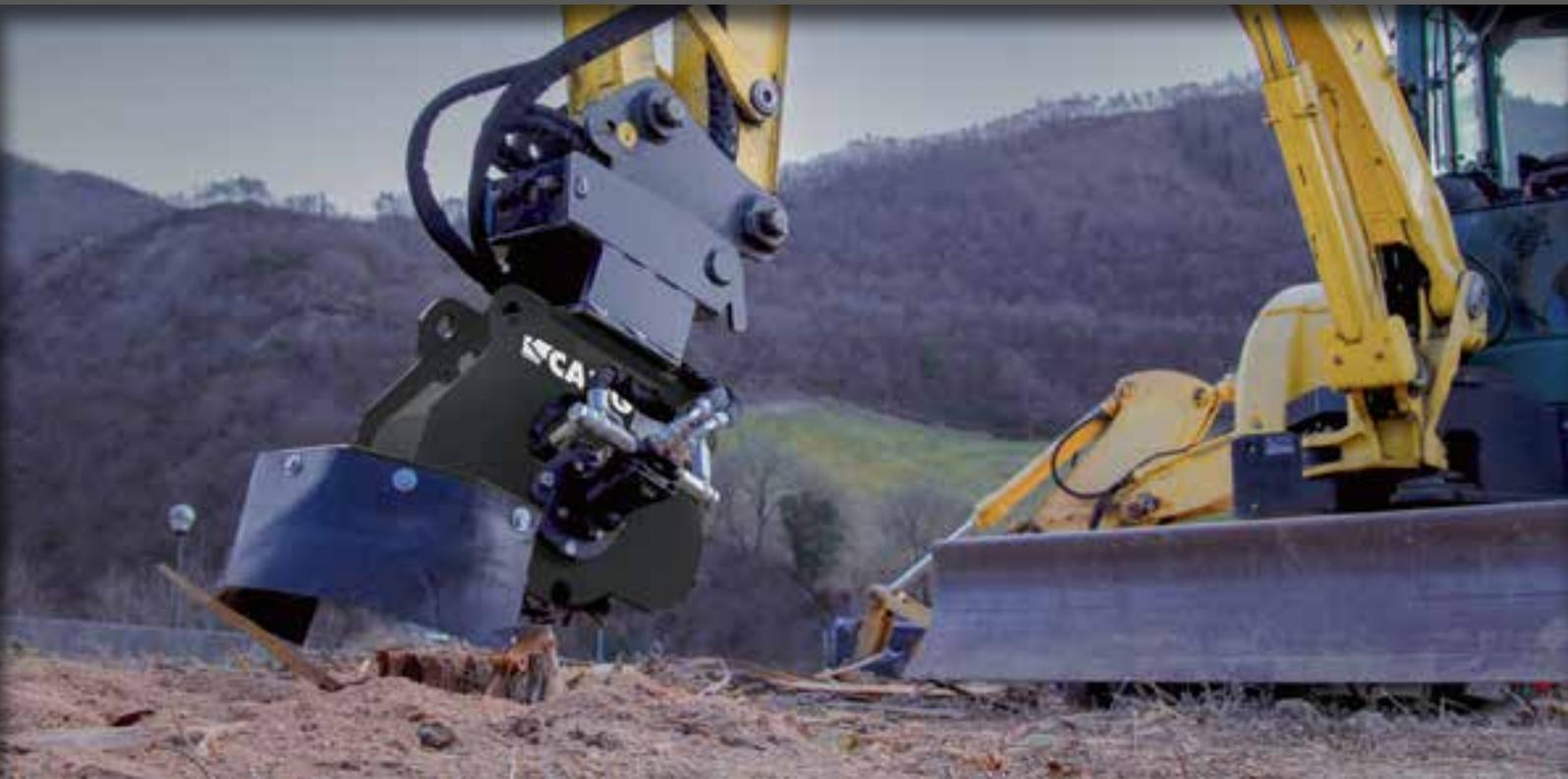
DIESE WURZELSTOCKFRÄSE DIENT ZUM SCHNELLEN UND EFFIZIENTEN ENTFERNEN VON BAUMSTÜMPFEN UND TIEFEN WURZELN. DAS HOLZ WIRD DURCH EIN VON EINER SEITE ZUR ANDEREN ARBEITENDES ZAHNRAD KOMPLETT ABGETRAGEN. DER DIREKTANTRIEB MIT KOLBENMOTOR SORGT FÜR EINE HOHE SCHNEIDGESCHWINDIGKEIT UND DAMIT OPTIMALE EFFIZIENZ UND PRODUKTIVITÄT. DIE ZÄHNE AUS KOHLENSTOFFGEHÄRTETEM WOLFRAM-KARBID SIND EXTREM ROBUST.
