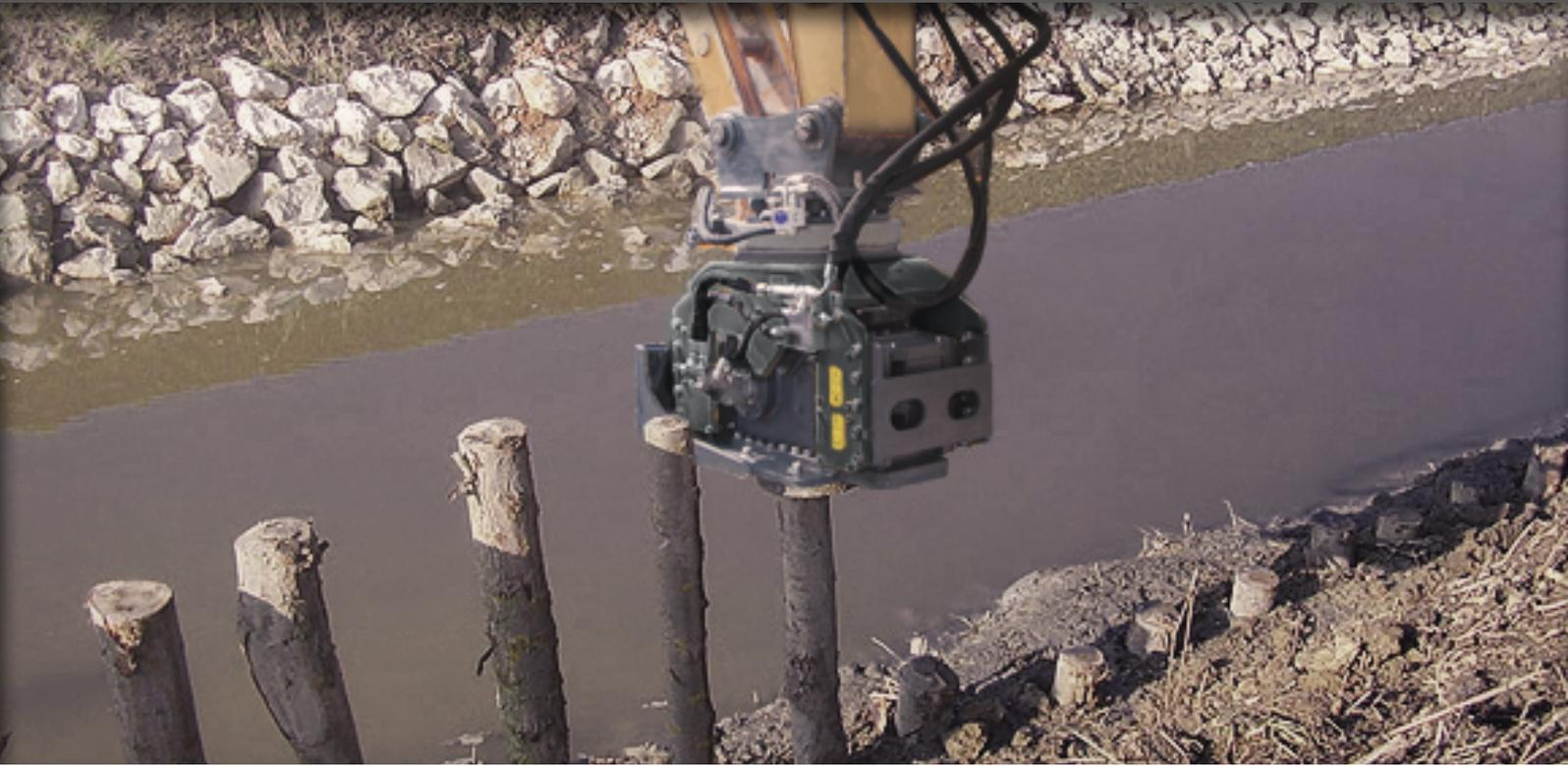
LE PIASTRE COMPATTATRICI POSSONO ESSERE EQUIPAGGiate DI KIT PER LA VIBROINFISSIONE DI PALI - COLLARE CENTRA-PALO. QUESTO STRUMENTO COSÌ COMPOSTO È IDEALE NEI LAVORI DI CONTENIMENTO DELLE FRANE, PER CREARE RECINZIONI E, IN AGRICOLTURA, PER L'IMPIANTO DI VIGNETI E FRUTTETI. L'ATTREZZATURA È COMPRESA DI ATTACCO FISSO ALLA MACCHINA. LA PRESSIONE VERSO IL BASSO ESERCITATA DALLA MACCHINA FORNISCE LA FORZA DI RESISTENZA NECESSARIA ALL'INFISSIONE.
