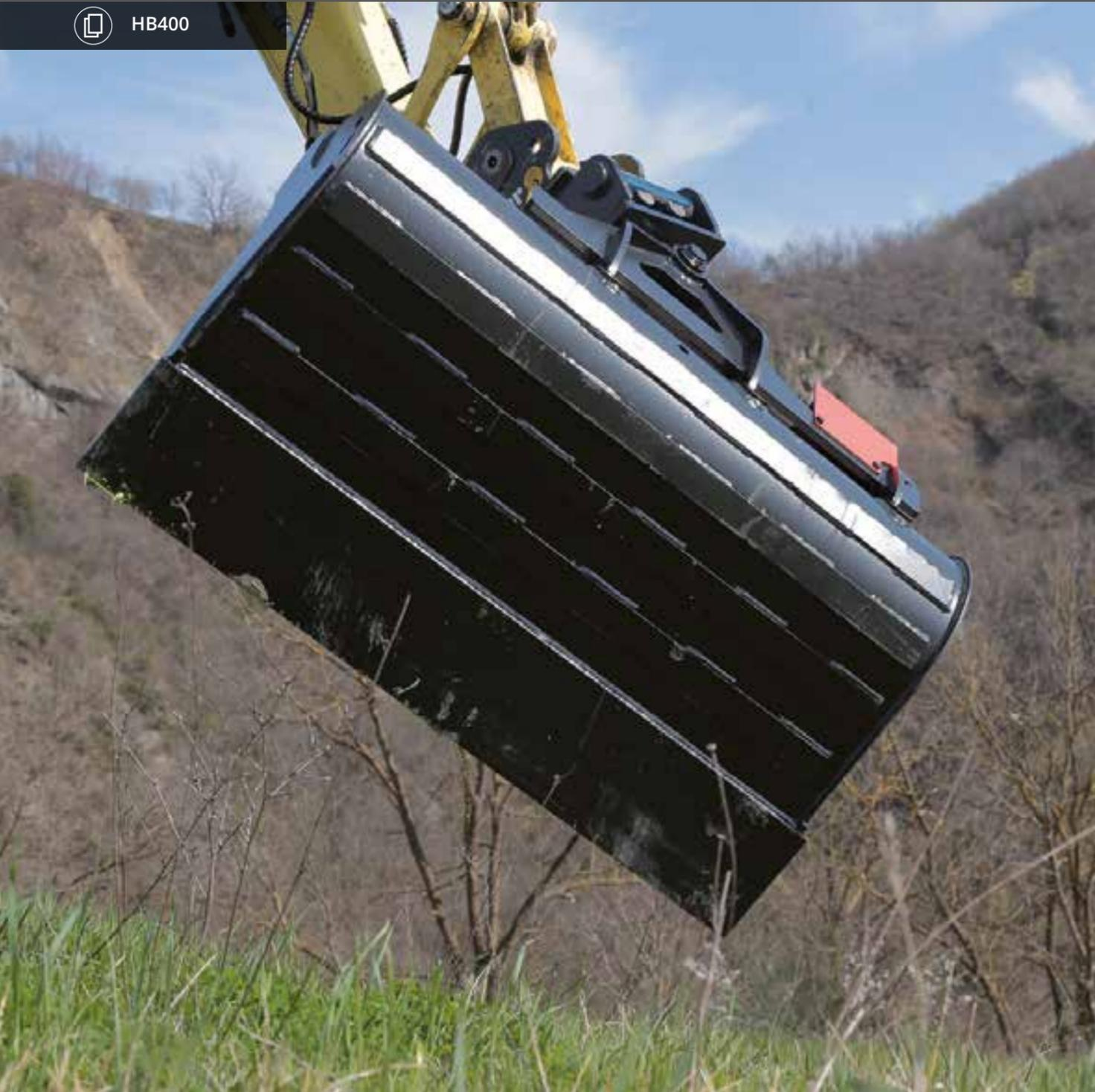
LOS REFUERZOS DE HB400 EN LOS PUNTOS MÁS SUJETOS A DESGASTE, LAS CUCHILLAS LATERALES REALIZADAS EN FUNDICIÓN Y UNA HOJA INFERIOR REVERSIBLE EMPERNADA HACEN QUE ESTE CAZO SEA IDEAL PARA TRABAJAR EN TERRENOS SUMAMENTE ABRASIVOS. MUY ADECUADA PARA TRABAJOS DE TERMINACIÓN Y NIVELACIÓN. SU SISTEMA OSCILANTE PERMITE INCLINAR EL CAJÓN 45° DE CADA LADO; LA VÁLVULA DE BLOQUEO, INCLUIDA EN LA VERSIÓN ESTÁNDAR, PERMITE MANTENER EL GRADO DE INCLINACIÓN.
