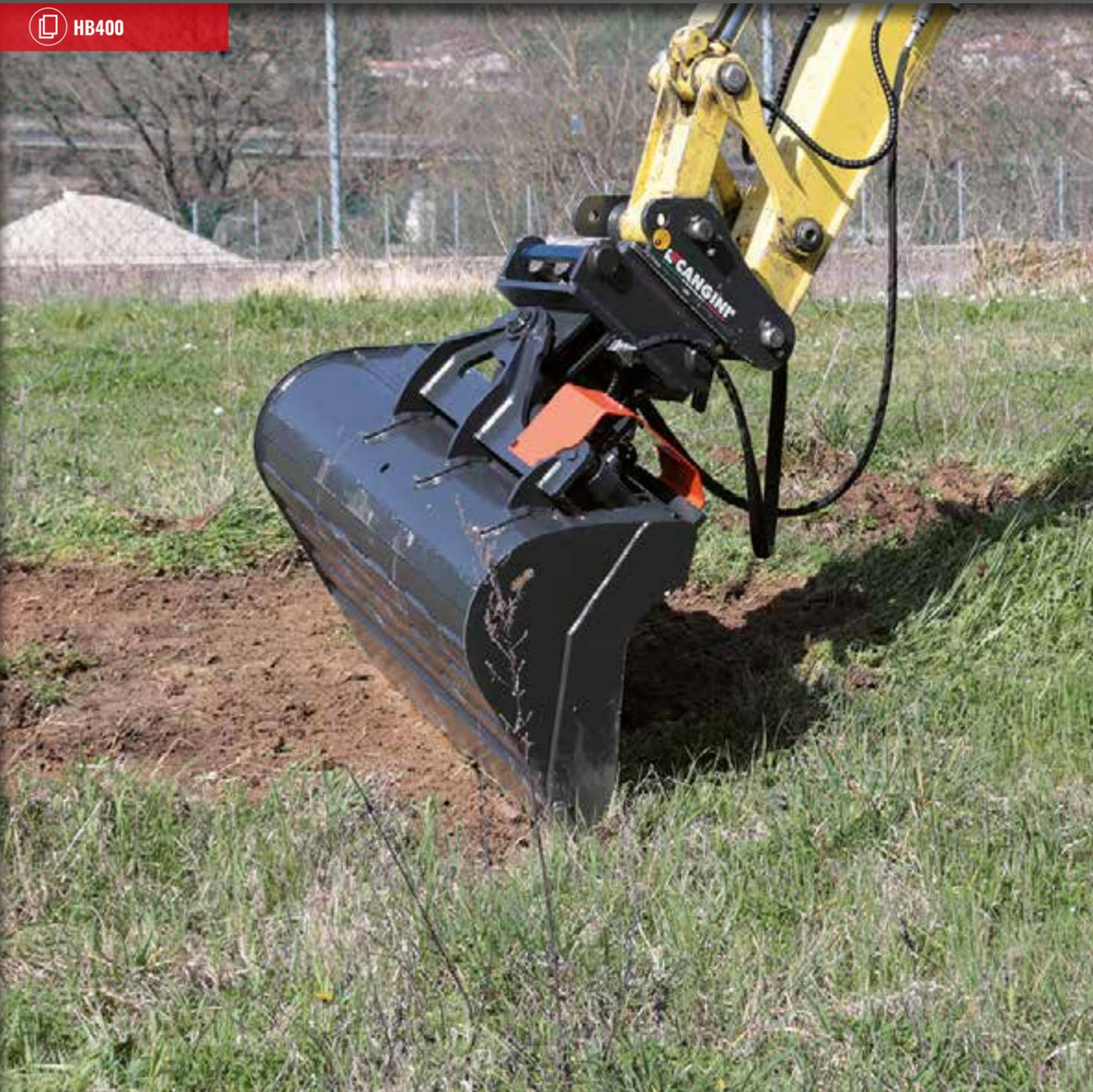
PARTICULIÈREMENT ADAPTÉ AUX TRAVAUX DE FINITION ET NIVELAGE. SON MOUVEMENT PERMET D'INCLINER LE GODET DE 45° SUR LES DEUX CÔTÉS. LA VANNE DE BLOCAGE DE SÉRIE PERMET DE TENIR L'INCLINAISON. SA FORME ALLONGÉE EMPÊCHE QUE LE TERRAIN ADHÈRE AUX PAROIS LATÉRALES DU GODET ET FACILITE LE DECHARGEMENT DES MATÉRIAUX ARGILEUX ET MOUILLÉS. INDIQUÉ POUR L'ENTRETIEN ET LE NIVELAGE DE ROUTES, FOSSÉS ET TALUS. LAME EN HB400.
