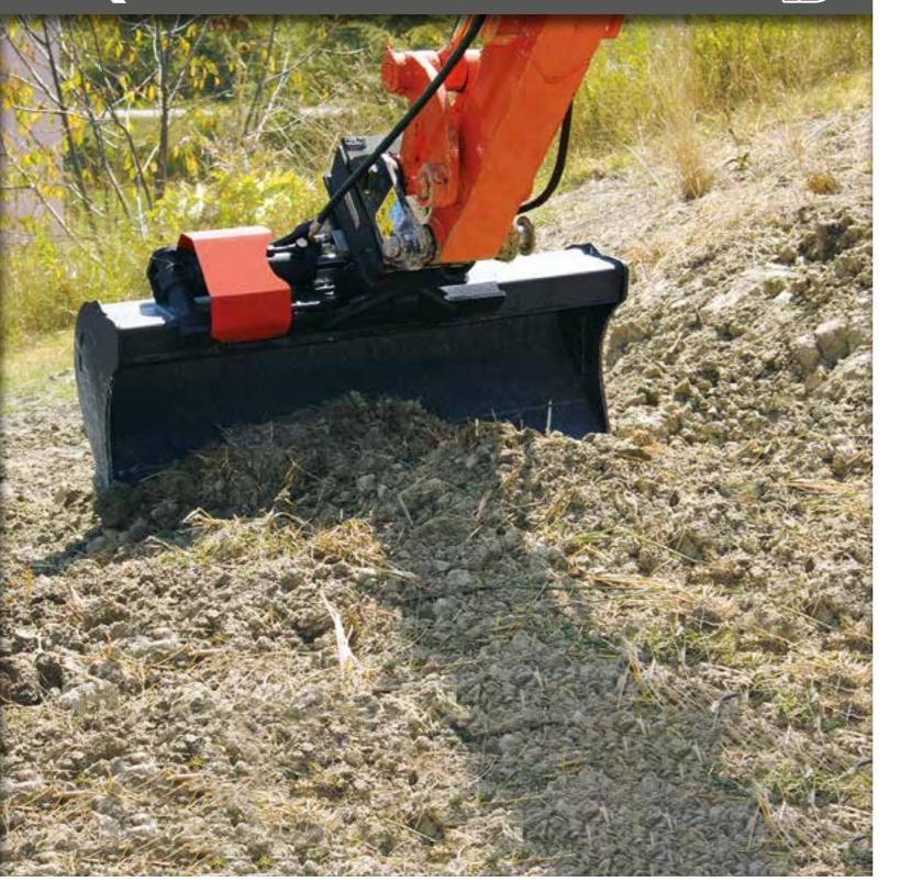
PARTICULIÈREMENT ADAPTÉ AUX TRAVAUX DE FINITION ET NIVELAGE. SON MOUVEMENT PERMET D'INCLINER LE GODET DE 45° SUR LES DEUX CÔTÉS. LA VANNE DE BLOCAGE DE SÉRIE PERMET DE TENIR L'INCLINAISON.
