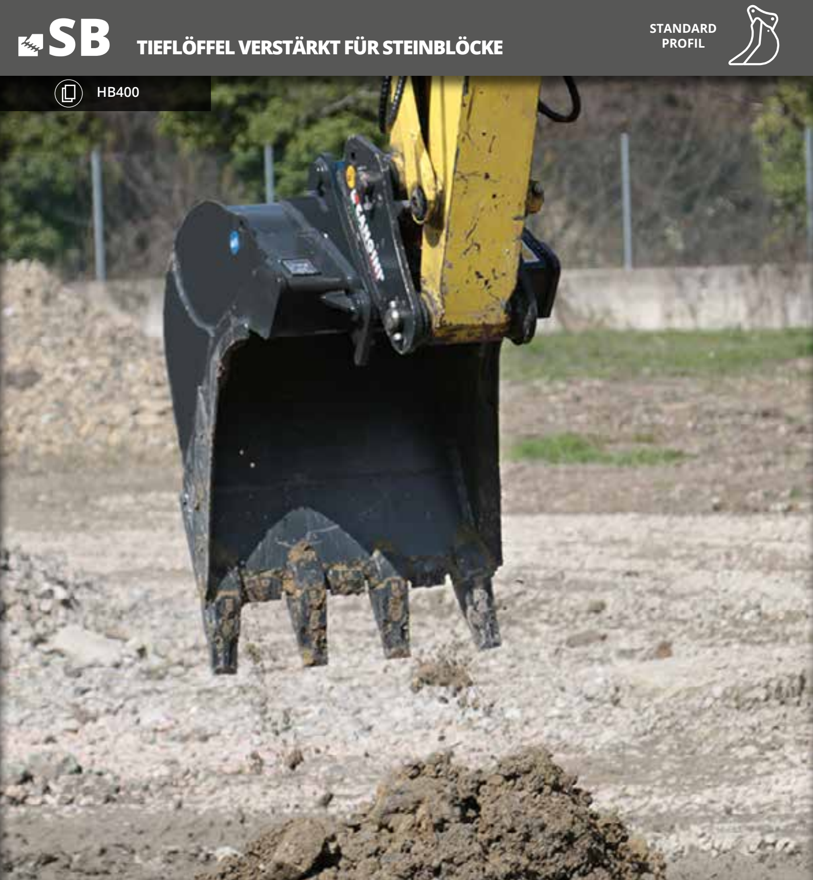
SPEZIALFORM FÜR EINFACHERE UND SICHERE STEINLEGEEINSÄTZE. EXTREM ROBUSTE AUSFÜHRUNG DER VERSCHLEISSBEANSPRUCHTEN TEILE IN HB400-STAHL.
