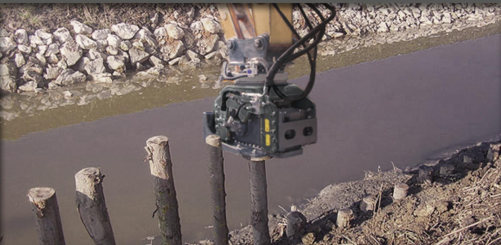
LES COMPACTEURS À PLAQUE PEUVENT ÊTRE ÉQUIPÉS DE KITS DE VIBROFONÇAGE DE POTEAUX ET D'UN COLLIER DE CENTRAGE POTEAU. CET OUTIL EST IDÉAL POUR LES TRAVAUX DE STABILISATION DES GLISSEMENTS DE TERRAIN, POUR LA RÉALISATION DE CLÔTURES ET, EN AGRICULTURE, POUR LA PLANTATION DE VIGNES ET DE VERGERS. L'ÉQUIPEMENT COMPREND UNE ATTACHE FIXE À L'ENGIN. LA PRESSION VERS LE BAS EXERCÉE PAR L'ENGIN FOURNIT LA RÉSISTANCE NÉCESSAIRE AU FONÇAGE.
