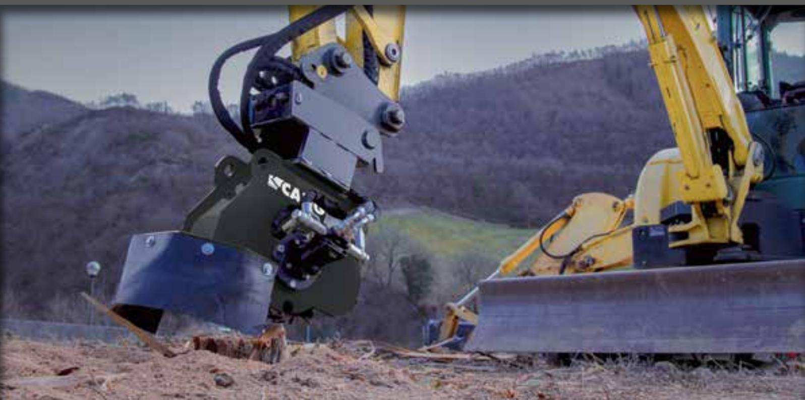
RAPIDE ET EFFICACE, CET ÉQUIPEMENT EST UTILE POUR ROGNER LES SOUCHES ET LE BOIS, Y COMPRIS EN PROFONDEUR, EN FAISANT PIVOTER LA ROUE DENTÉE D'UN CÔTÉ À L'AUTRE ET EN AVANÇANT PROGRESSIVEMENT DANS LA SOUCHE POUR L'ÉLIMINER COMPLÈTEMENT. LE SYSTÈME D'ENTRAÎNEMENT DIRECT AVEC MOTEUR À PISTONS PERMET UNE VITESSE DE COUPE MAXIMALE ET DONC UNE PRODUCTIVITÉ ET UNE EFFICACITÉ OPTIMALES. LES DENTS EN CARBURE DE TUNGSTÈNE SONT TRÈS RÉSISTANTES.
