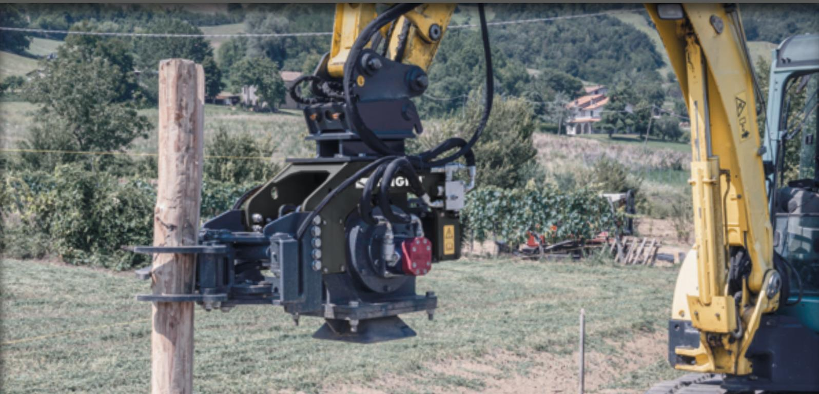
LES COMPACTEURS À PLAQUE PEUVENT ÊTRE ÉQUIPÉS D'UN KIT DE VIBROFONÇAGE DE POTEAUX - COLLIER DE CENTRAGE POTEAU - ET D'UNE PINCE POUR LA PRÉHENSION DES POTEAUX EN BOIS OU EN BÉTON-ACIER. CET OUTIL EST IDÉAL POUR LES TRAVAUX DE STABILISATION DES GLISSEMENTS DE TERRAIN, POUR LA RÉALISATION DE CLÔTURES ET, EN AGRICULTURE, POUR LA PLANTATION DE VIGNES ET DE VERGERS, AINSI QUE POUR LA PRÉPARATION D'UNE BASE SOLIDE POUR LE PAVAGE ET BIEN D'AUTRES APPLICATIONS SIMILAIRES.
