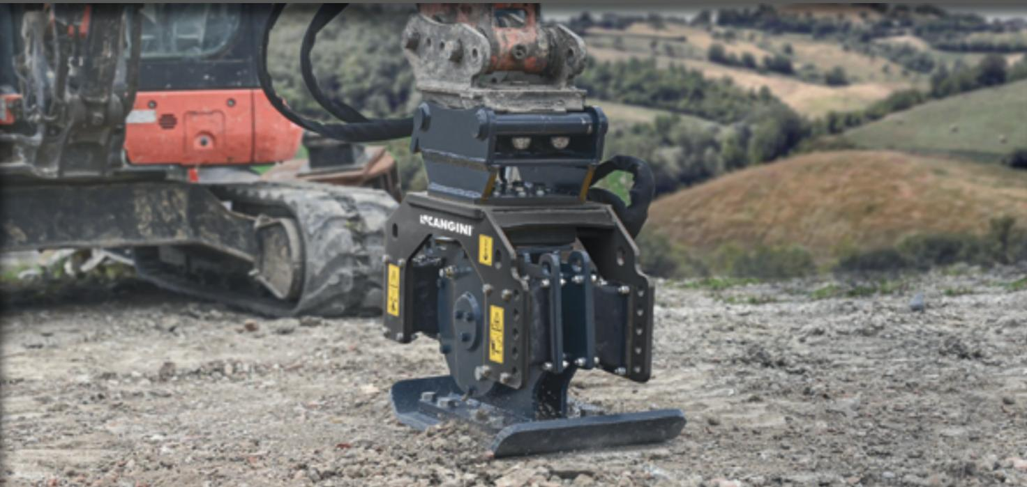
DISEÑADA PARA COMPACTAR CUALQUIER TIPO DE SUPERFICIE, LA PLACA VIBRATORIA RESULTA SUMAMENTE ÚTIL PARA LA COMPACTACIÓN DEL MATERIAL DE RELLENO EN LAS ZANJAS REALIZADAS PARA EL ENTERRAMIENTO DE CABLES Y TUBOS. GARANTIZA UN FONDO SÓLIDO Y HOMOGÉNEO DE GRAN DURACIÓN. EL EQUIPO INCLUYE LA PIEZA DE ENGANCHE FIJO A LA MÁQUINA.
