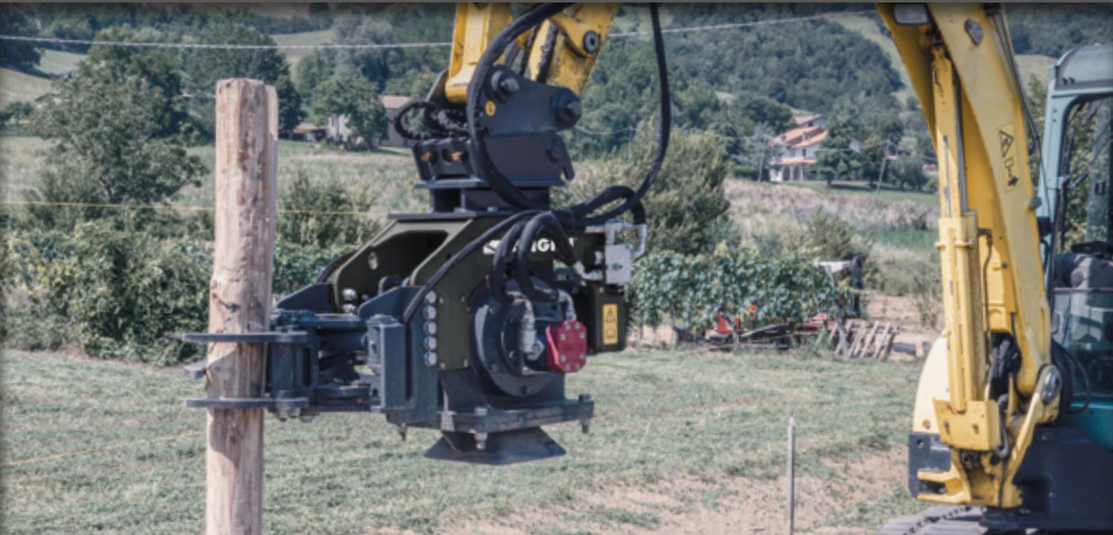
LAS PLACAS COMPACTADORAS PUEDEN EQUIPARSE CON KIT PARA EL HINCADO DE POSTES POR VIBRACIÓN –COLLAR DE CENTRADO POSTE– Y CON PINZA PARA LA TOMA DE POSTES DE MADERA O CEMENTO Y ACERO. CON TALES ACCESORIOS, ESTA HERRAMIENTA ES IDEAL PARA OBRAS DE CONTENCIÓN DE DESPRENDIMIENTOS DE TIERRA, REALIZACIÓN DE CERCADOS, ASÍ COMO EN AGRICULTURA, PARA LA PLANTACIÓN DE VIÑAS Y ESPECIES FRUTALES, PARA PREPARAR UNA BASE SÓLIDA DE PISOS Y MUCHOS OTROS USOS SIMILARES.
