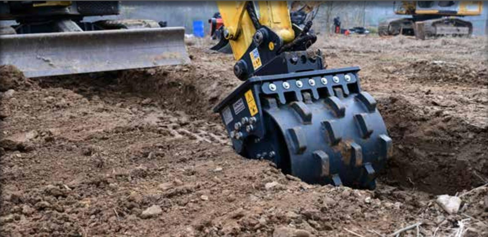
ZUM VERDICHEN VON BÖDEN ODER AUFFÜLLMATERIAL, FÜR EINEN HOMOGENEN UND DAUERHAFT FESTEN UNTERGRUND. DIE VERDICTERRÄDER HABEN KEGELROLLENLAGER UND SIND SO KONZIPIERT, DASS EIN REIBUNGSLOSES ARBEITEN MIT HOHER VERDICHUNG GEWÄHRLEISTET IST. SIE SIND IN 4 AUSFÜHRUNGEN VON 1,5 BIS MAXIMAL 20 T ERHÄLTLICH. EXTREM ROBUSTER STAHL UND DAUERHAFT LAGER GEWÄHRLEISTEN EINE LANGE LEBENSDAUER DER AUSRÜSTUNG. DAS GERÄT WIRD MIT EINER FIXEN KUPPLUNG FÜR DEN ANSCHLUSS AN DIE TRÄGERMASCHINE GELIEFERT.
