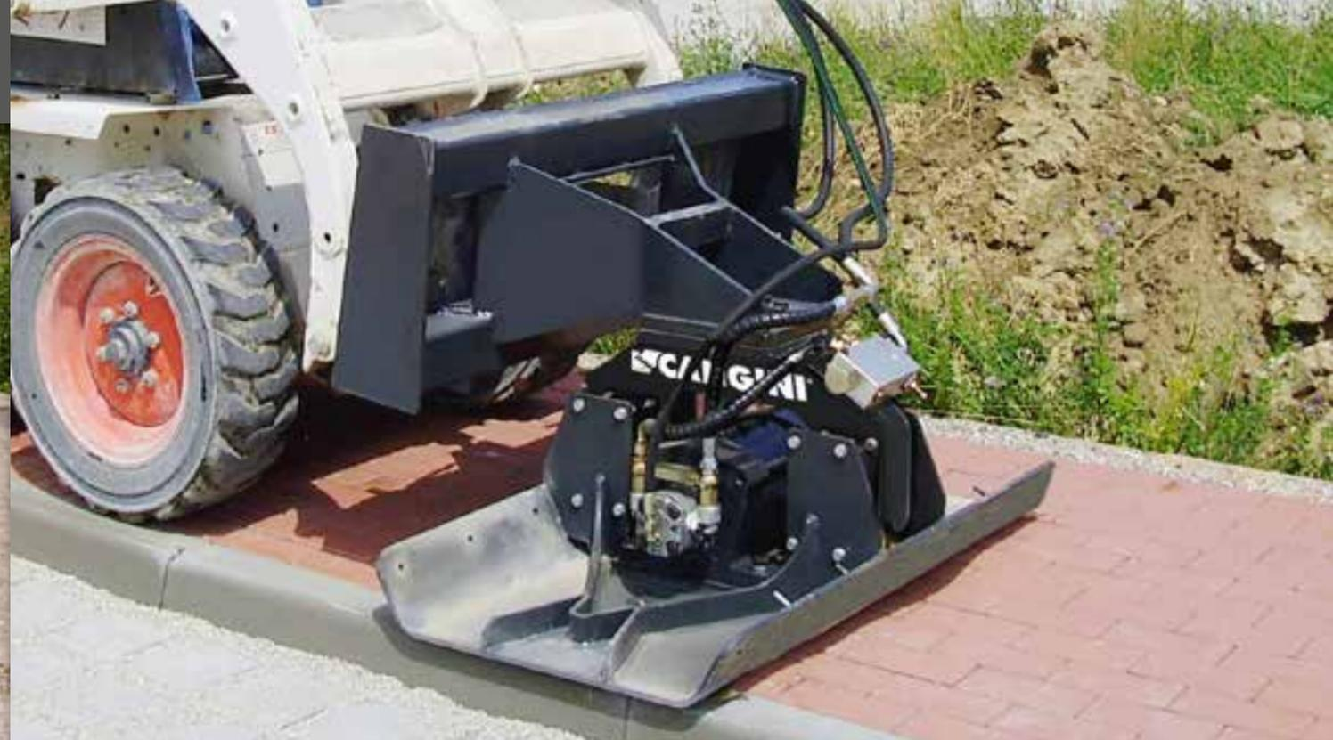
ZUM VERDICHTEN ALLER FLÄCHEN, IM BESONDEREN DES UNTERGRUNDES VON STRASSENBELÄGEN UND ZUM ERRICHTEN VON RAD- UND FUSSGÄNGERWEGEN. DAS ERGEBNIS IST EIN DAUERHAFT FESTER, HOMOGENER BODEN.
