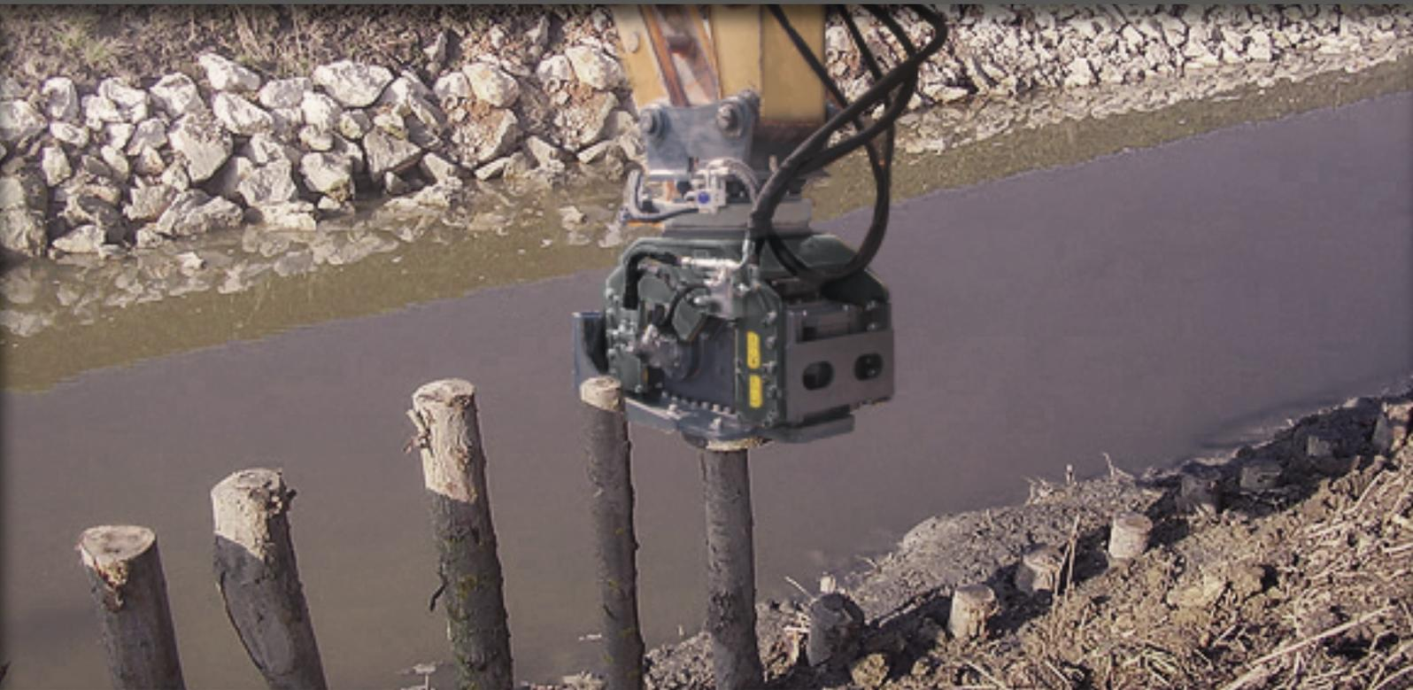
DIE VERDICHTER KÖNNEN MIT EINEM BAUSATZ ZUM EINTREIBEN VON PFÄHLEN UND EINER ZENTRIERVORRICHTUNG AUSGESTATTET WERDEN. DIESE AUSTRÜSTUNG IST UNVERZICHTBAR FÜR DIE ERDRUTSCHSICHERUNG, DIE HERSTELLUNG VON EINFRIEDUNGEN, IN DER LANDWIRTSCHAFT IM ALLGEMEINEN SOWIE IM OBST- UND WEINBAU IM SPEZIELLEN. DAS GERÄT WIRD MIT EINER FIXEN KUPPLUNG FÜR DEN ANSCHLUSS AN DIE TRÄGERMASCHINE GELIEFERT. DER VON DER MASCHINE NACH UNTEN AUSGEÜBTE DRUCK LIEFERT DIE FÜR DAS EINTREIBEN ERFORDERLICHE WIDERSTANDSKRAFT.
