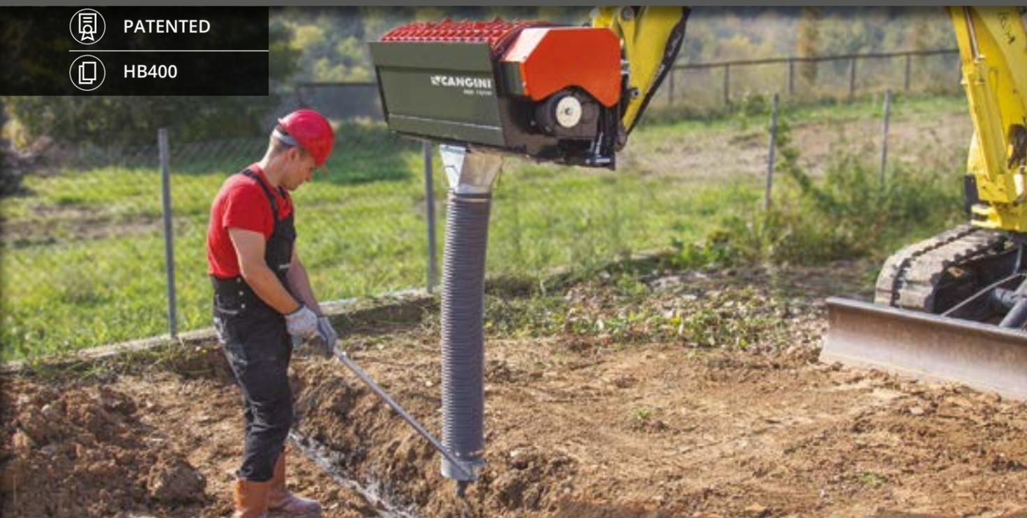
DOTATA DI TRASMISSIONE A RIDUTTORE AD INGRANAGGI, CHE GARANTISCE ELEVATE PRESTAZIONI E NON NECESSITA DI MANUTENZIONE COSTANTE. L'UTILIZZO DI VALVOLE DI MASSIMA PRESSIONE INCROCIATE E RIDUTTORE DI FLUSSO GARANTISCE EFFICIENZA E AFFIDABILITÀ ANCHE NELLE CONDIZIONI DI LAVORO PIÙ GRAVOSE.
