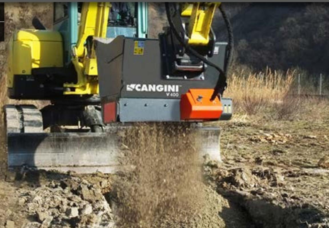
SE UTILIZA PARA LA SELECCIÓN DE ESCOMBROS DE DEMOLICIÓN O EXCAVACIONES EN GENERAL Y PARA LA MEZCLA DE TERRENOS CON TURBA. EL CRIBADO SE REALIZA MEDIANTE UNA CRIBA HIDRÁULICA CON CUCHILLAS GIRATORIAS EN HB400. EL ESPESOR DEL MATERIAL CRIBADO PUEDE VARIAR DE 0-20 MM A 0-35 MM EN LA CONFIGURACIÓN ESTÁNDAR. BAJO PEDIDO, ES POSIBLE REALIZAR EJES ADECUADOS A LAS NECESIDADES DEL USUARIO.
