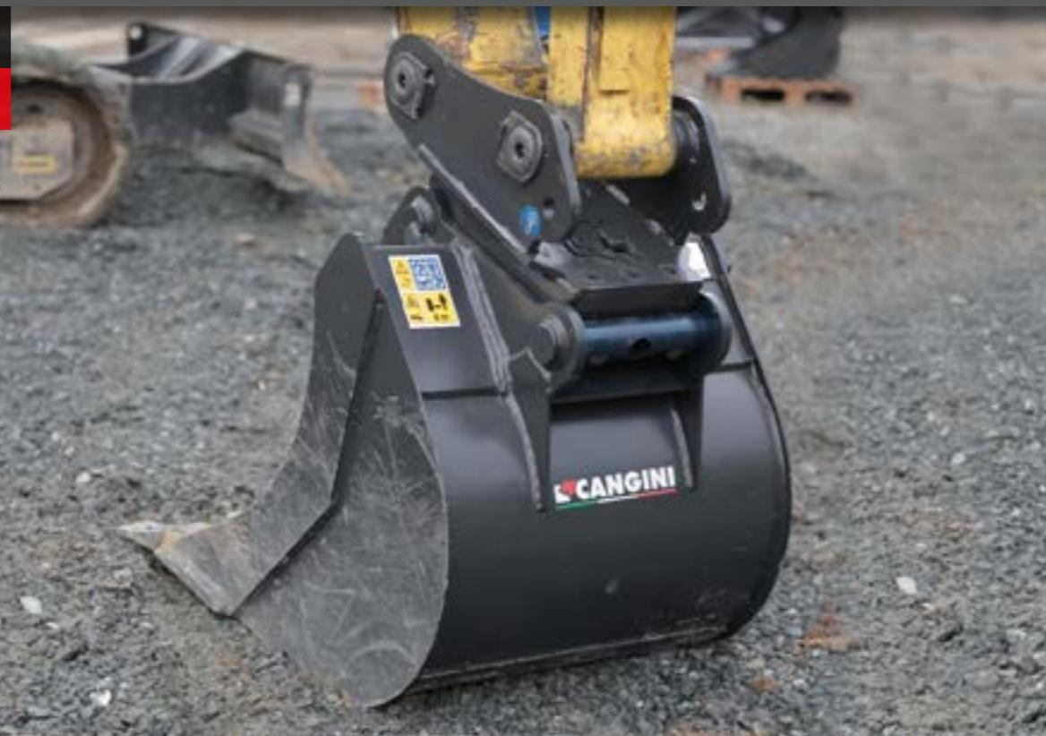
L'ATTACCO RAPIDO CS SCHNAPPOMATIC D.E. CON SISTEMA A **DOPPIO EFFETTO**, GESTISCE LE OPERAZIONI DI AGGANCIO E SGANCIO DIRETTAMENTE DALLA CABINA IN POCHI SECONDI. È DOTATO DEI SISTEMI PIÙ AVANZATI IN MATERIA DI SICUREZZA: **LA VALVOLA DI BLOCCO INTEGRATA DI SERIE, L'INDICATORE PER LA VISUALIZZAZIONE DEL CORRETTO STATO DI AGGANCIO E LA FORCELLA DI AGGANCIO A DOPPIA SEDE**. LA FORCELLA IN HB400 RENDE L'ATTACCO ROBUSTO, ADATTO AD UN ELEVATO CARICO DI LAVORO, GARANTENDONE UNA LUNGA DURATA.
